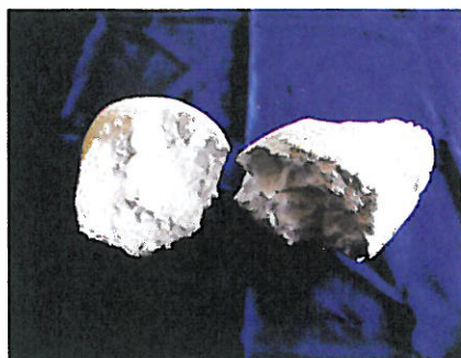
Bild 1: Flintgestein nach dem Brennen bei ca. 1.200°C
